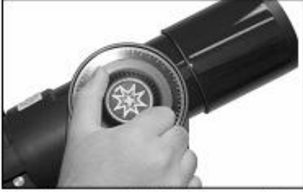
Adım 2: Optik tüpün hareket etmesi için Dikey kilidi gevşetin.
