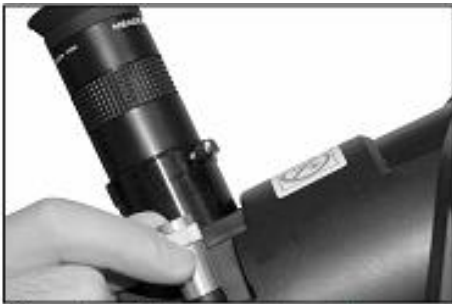
Adım 4 ve 6: Gözmerceğinin takılması ve teleskobunuzun odaklanması.
