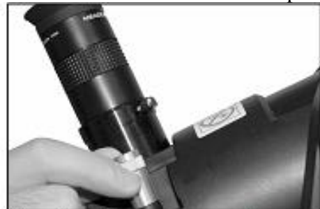
Adım 4 ve 6: Gözmerceğinin takılması ve teleskobunuzun odaklanması.
